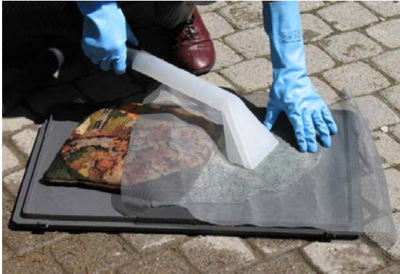
Abb. 10 Absaugen von Wasser aus Textilien mit einem Wassersauger durch Fliegengitter
