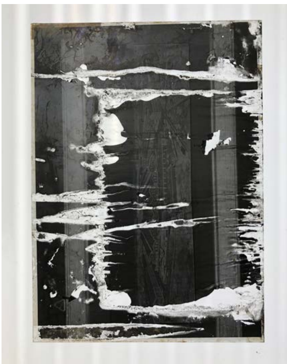
Abb. 2 Glasplattennegativ mit aufgelöster und zerflossener Emulsionsschicht.
